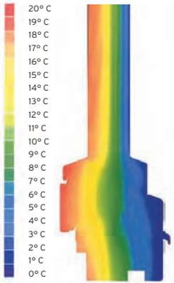
Der gute Isothermenverlauf ist durch die Wärmebildmessung sichtbar gemacht: deutliche Darstellung der Trennungen von Wärme- und Kältezonem. Die Wärme wird im Haus gehalten, die Kälte bleibt ausgesperrt.
