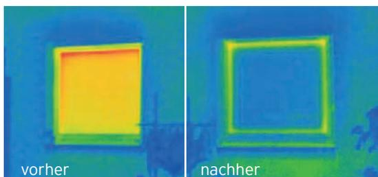
Mit einer Thermografie (Wärmebildaufnahme) wird der Wärmeverlust sichtbar. Die roten und orangefarbenen Bereiche beim alten Fenster links zeigen außen eine Temperatur zwischen 5 und 8°C. Die grünen und blauen Bereiche beim neu eingebauten **ewitherm**<sup>®</sup>-Fenster rechts entsprechen 0-2°C. Der Großteil der Heizenergie bleibt erhalten.
